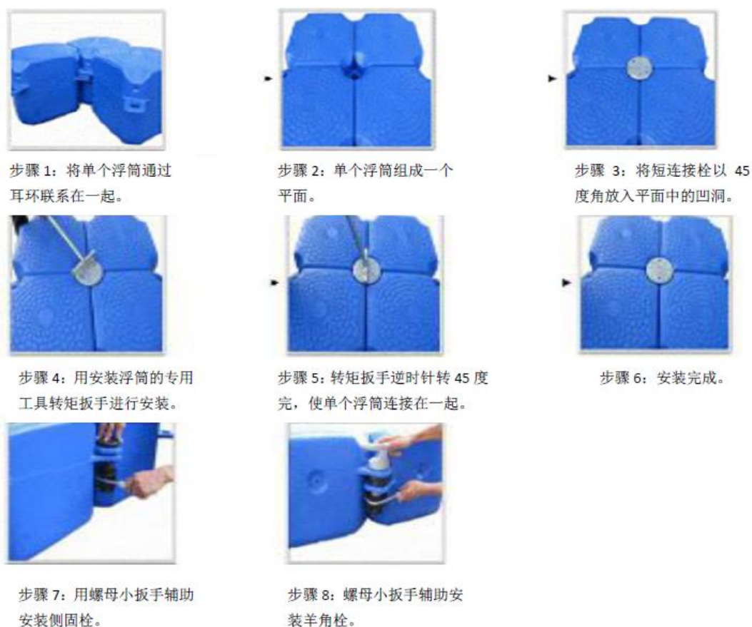
图 2.3-1 组装连接示意图
