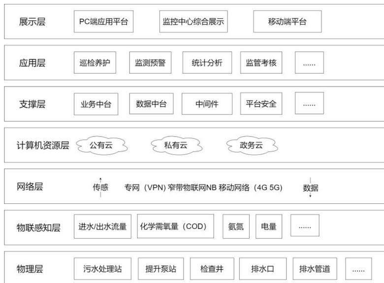
图 5.4.1 支撑平台总体架构
