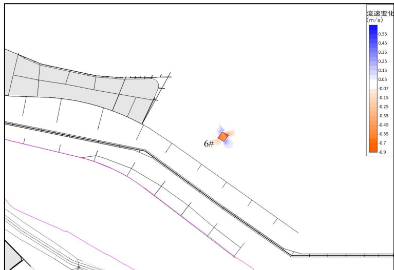
图 3.1-29 6#主采区采砂前后涨急流速差变化图（枯季）
