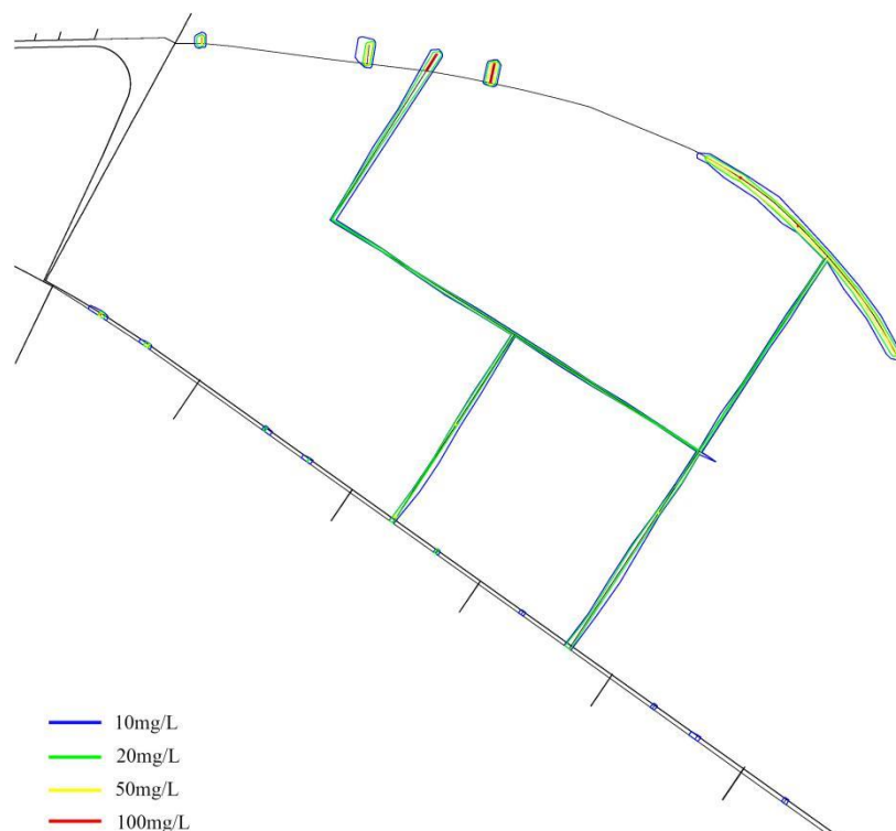
图 4.3-10 推荐方案施工悬浮物扩散最大影响包络线
