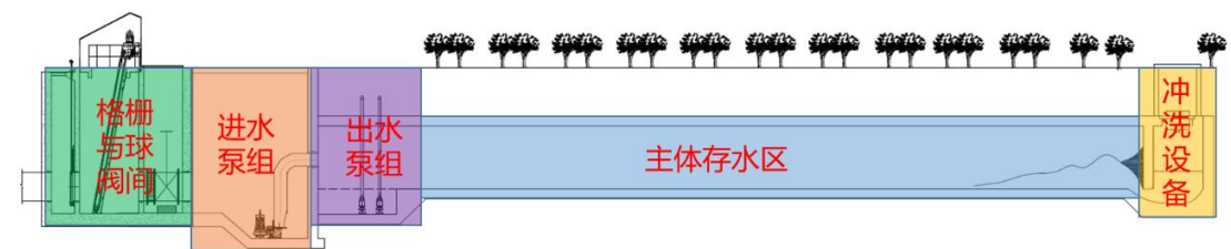
图 22 岸后式调蓄箱涵立面示意图
