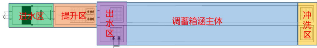
图 25 齐岸式调蓄箱涵平面示意图
